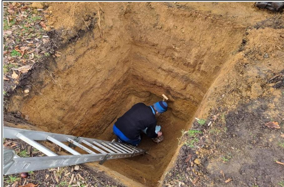
**Abb. 1:** Versickerungsversuch in Schurf 1
