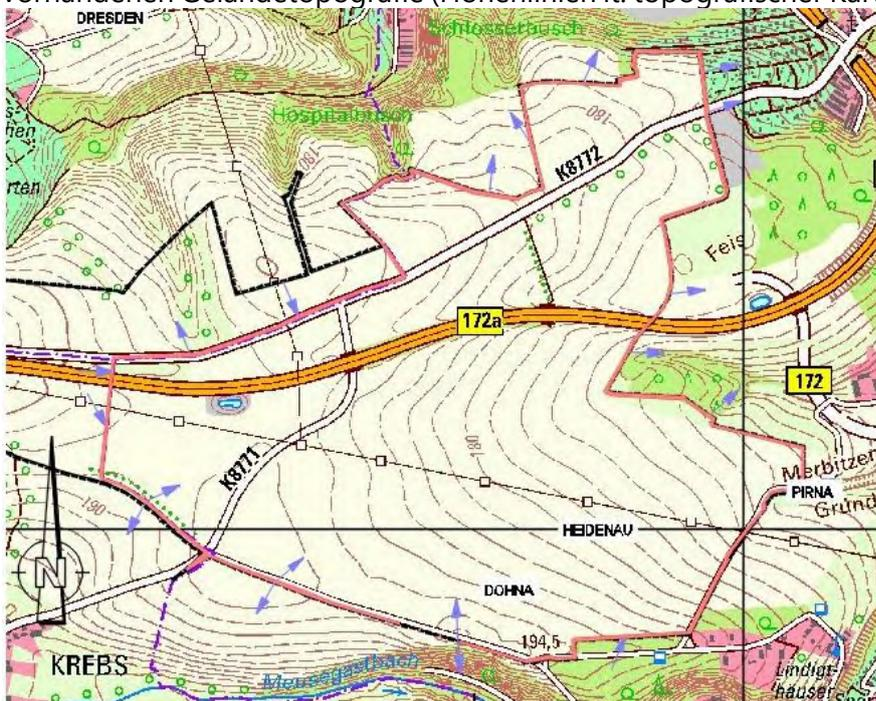
Abbildung 6 Fließrichtung von Starkregenabflüssen an der Gebietsgrenze
