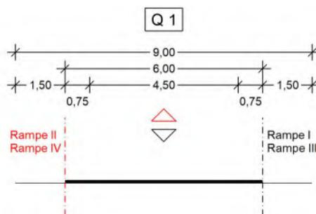
Abbildung 5: Regelquerschnitt Q 1 gemäß RAA
