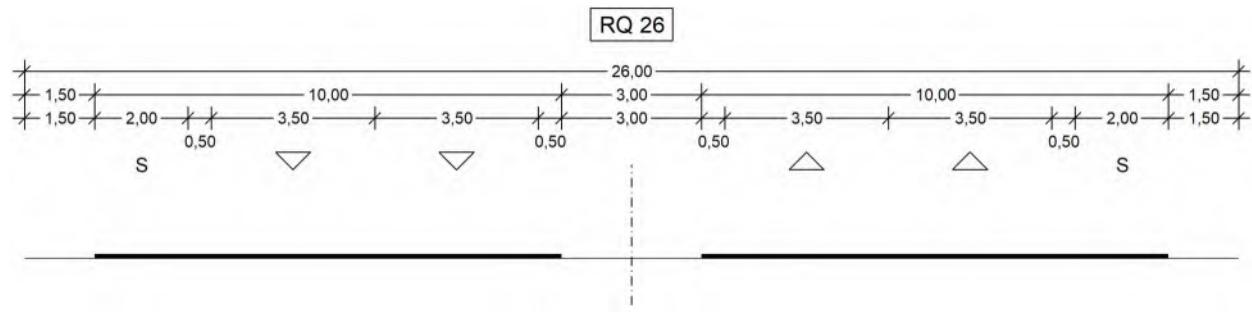
Abbildung 3: Regelquerschnitt RQ 26 gemäß RAS-Q 96
