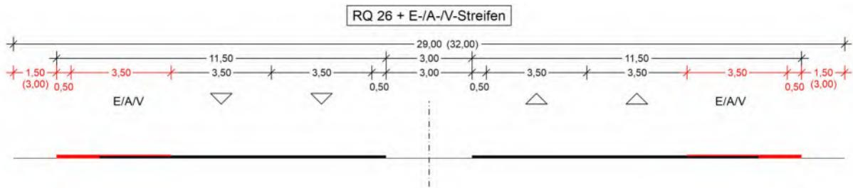
Abbildung 4: Regelquerschnitt RQ 26 gemäß RAS-Q 96 mit Ein-/Ausfädelungs-/Verflechtungsstreifen
