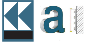
3_ leuchtendes Logo, Front aus Acryl, ähnlich RAL 9010 Reinweiß, Aluminiumgrundkörper leuchtend, lackiert in RAL 5009 Auszubau, Montage auf selbsttragender und auskragender UK, nach stat. Erfordernis festverschraubt und/ oder mit Auflast auf der Fassade gesichert Größe bsh: 6,0 x 7,20m
