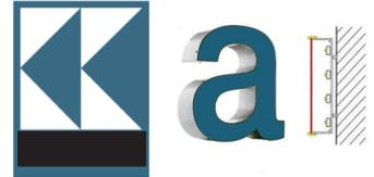
3\_ leuchtendes Logo, Front aus Acryl, ähnlich RAL 9010 Reinweiß, Aluminiumgrundkörper lichtdicht, lackiert in RAL 5009 Anstraub, Montage auf selbsttragender und auskragender UR, nach stat. Erfordernis festverschraubt und/ oder mit Auflast auf der Fassade gesichert Größe bsh: 6,0 x 7,20m
