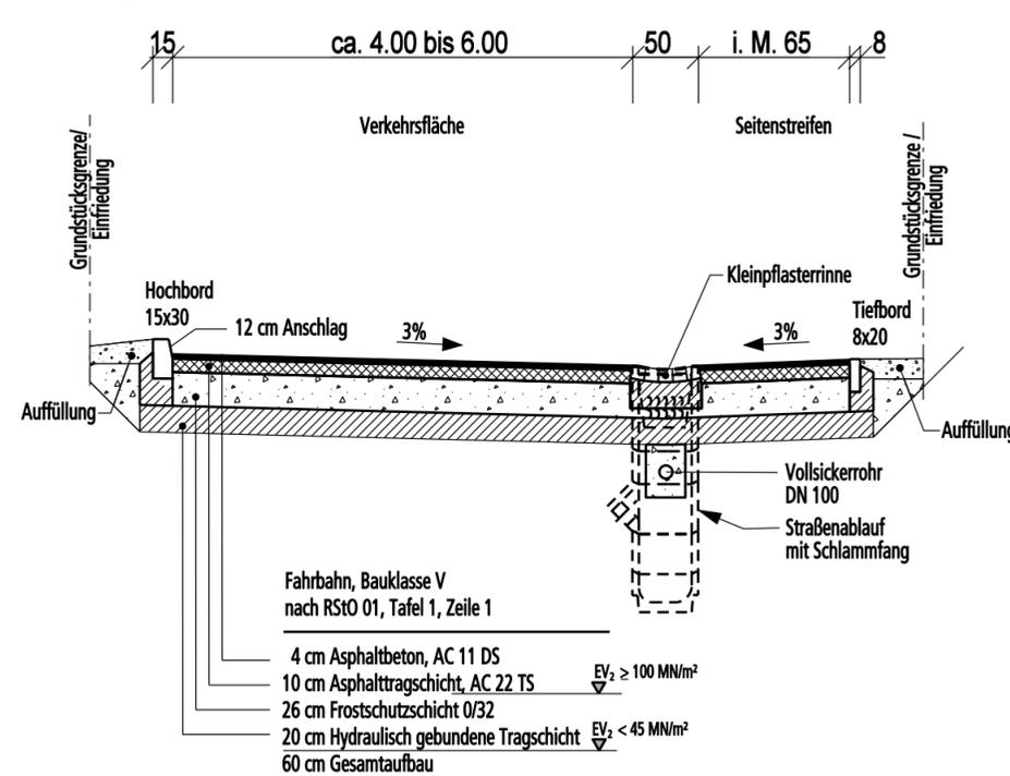
Regelquerschnitt G - G
