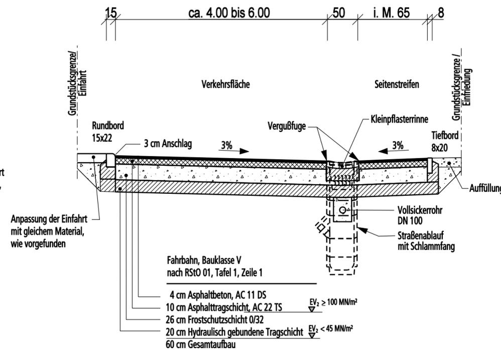
Regelquerschnitt F - F
