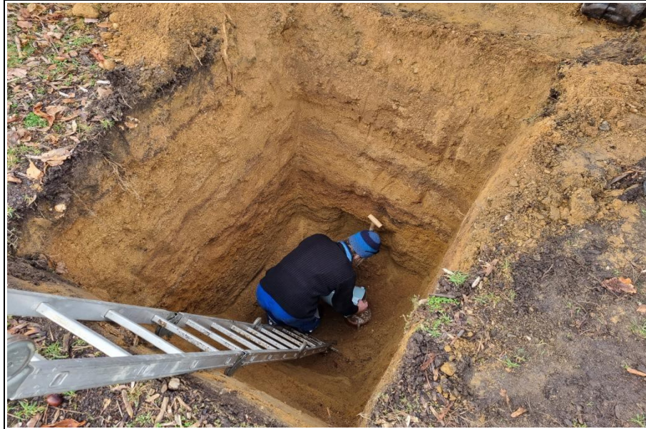
Abb. 1: Versickerungsversuch in Schurf 1
