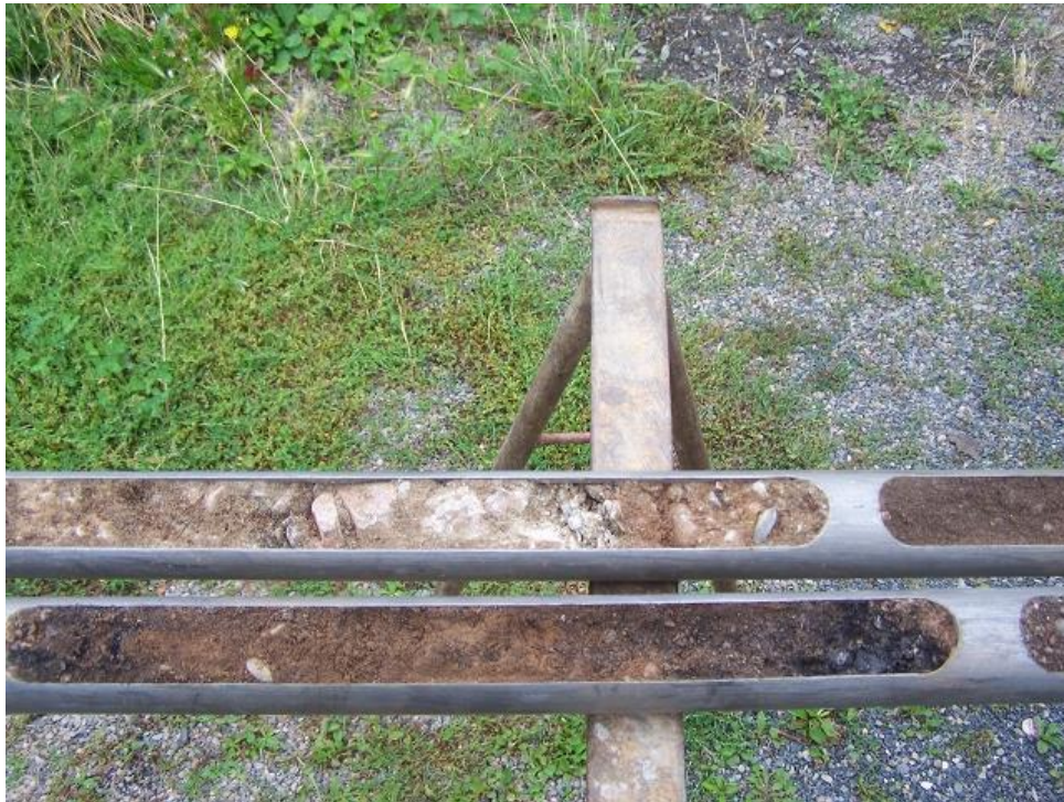
Bild 21: RKS 16/14 Beispielhafte Darstellung des Bohrprofils bis 3,0 m u. GOK mit gut sichtbaren Auffüllungen von Betonresten und Bauschutt
