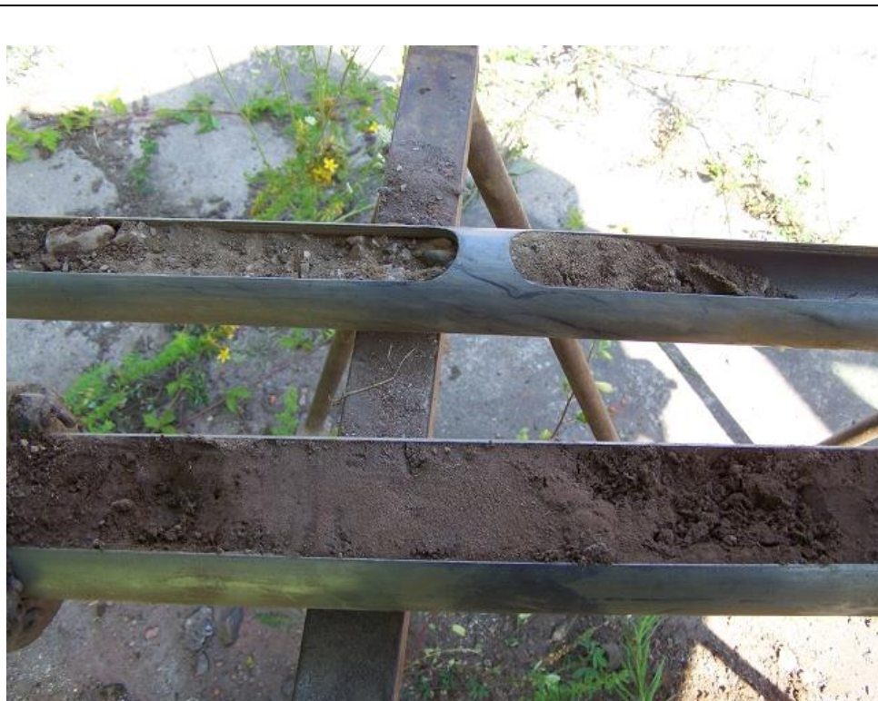
Bild 7: RKS 04/14 Bohrprofil bis 1,70 m u. GOK natürlich gewachsener Boden (Mittel- und Feinsand)
