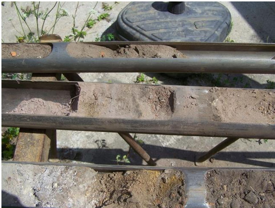
Bild 5: RKS 03/14 Beispielhafte Darstellung des Bohrprofils bis 3,0 m u. GOK in den oberen 0,6 m Auffüllungen von Beton und Bauschutt
