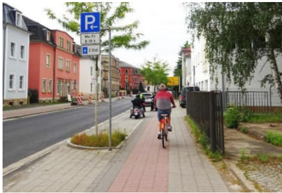
Foto: max. 2,50 m Gehweg („Rad frei“) zugunsten an der Straße längsparkender Kfz, südlich der Heinrich-Heine-Straße
