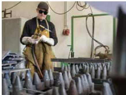
*In manchen Fällen ist ein Schneiden der Platten und Rohre nur manuell möglich.*
