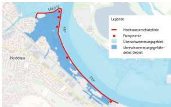
Abb. 10: Verlauf der Hochwasserschutzlinie an der Elbe
