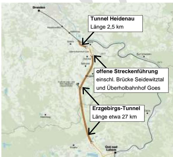
Abb. 5: Teiltunnelvariante (voraussichtlich keine Realisierung) Quelle: DB Netze, 8. Dialogforum, 23. November 2022
